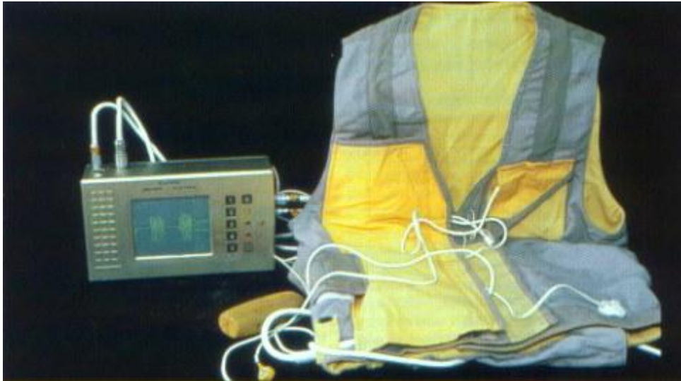
Abb. 2: In einer Sensorjacke aus Leinen und Merinowolle sind die Kabel zusammengefaßt, um ein störendes Kabelgewirr zu vermeiden. Ein 16-Kanal-Datenaufzeichnungsgerät (KYMO) zeichnet die gemessenen Analogdaten digital auf. Ein Gerät gleicher Bauart wird auf der Raumstation MIR zur Aufzeichnung physiologischer Parameter bei Kosmonauten eingesetzt.
